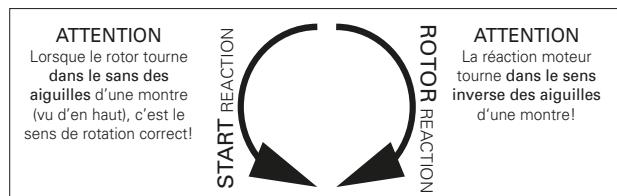
Pour les grosses pompes, on peut aussi déterminer le sens de rotation en regardant dans la chambre de pompage par la tubulure de pression. On y voit le rotor et, après une brève mise en marche, on peut contrôler le sens de rotation lors de l'arrêt du rotor.
