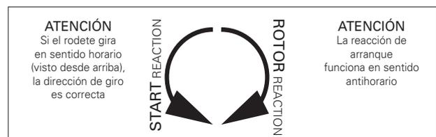
En el caso de bombas grandes, también se puede detectar la dirección de giro mirando a través de la boca de impulsión hacia la cámara de la bomba. Aquí se puede ver el rodete y, después de un breve encendido, se puede controlar la dirección de giro cuando el rodete se va deteniendo.
