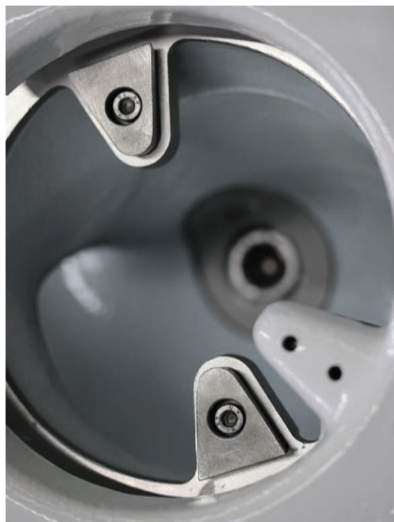
Wymienne ostrza tnące z węgliku spiekanego (HRC 55) systemu ASC.
