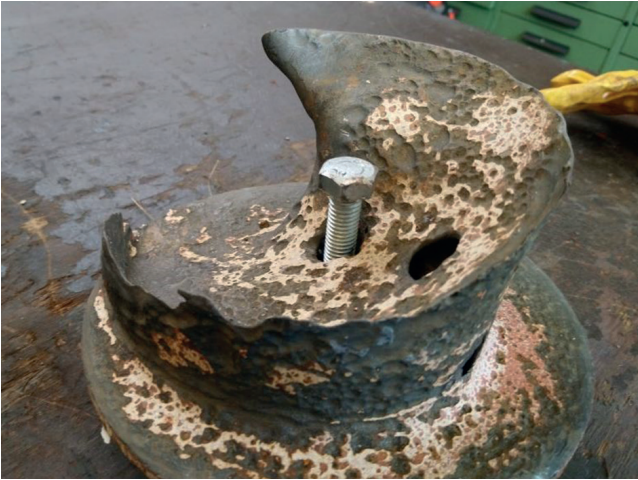
Alte Tauchmotor-Pumpe nach 8 Monaten im CIP-Abwasser
